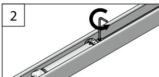
Desserrer les arrêts de l'axe d'enroulement.
