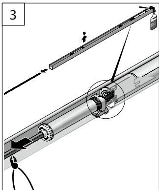
Retirez l'axe d'enroulement latéralement de la tête du moteur.
